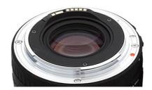
Les objectifs sont a commande électrique, le connecteur 8 points du boiter est composé d'un bloc de 3 assurant les fonctions d'alimentation de puissance et de détection de l'objectif et d'un groupe de 5 concernant la partie dialogue informatique. Attention lors de l'utilisation de bagues et d'objectifs dotés de tige de commande de diaphragme que celle-ci ne touche ou abime les contacts électriques du boitier.
